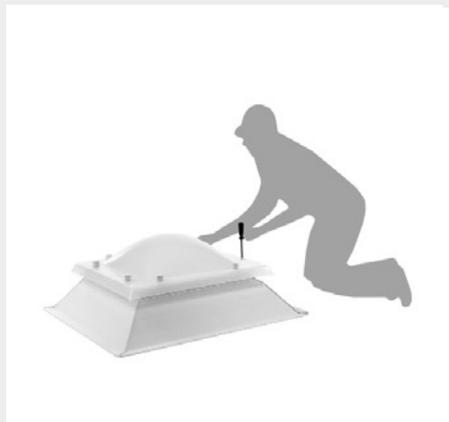
Móntese la cúpula sobre el zócalo, sin apretar excesivamente los tornillos para evitar el riesgo de rotura de la cúpula o anular el efecto de la arandela de dilatación. No sellar con silicona las cúpulas.
