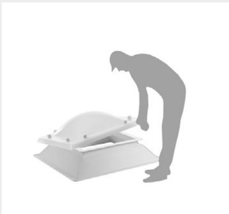
Presentar la cúpula sobre el zócalo, centrar y marcar los agujeros en el zócalo y retirar la cúpula. Taladrar el zócalo con broca de hierro de 5 mm.
